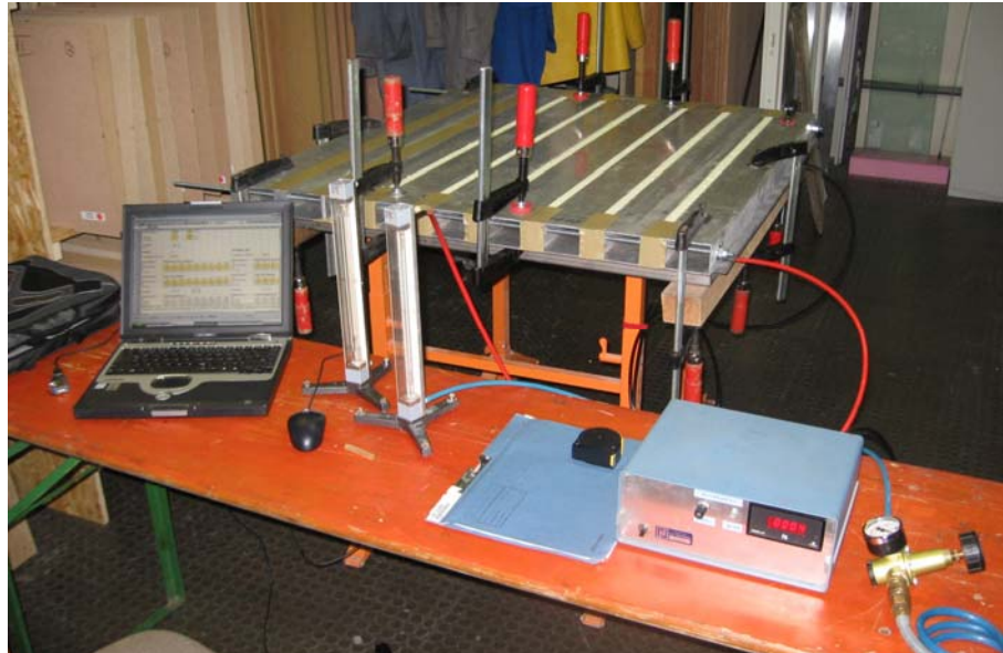
Abbildung 2 Messeinrichtung mit Durchfluss- und Druckmesseinheit.
